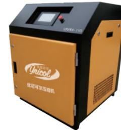
渦旋空氣壓縮機是由兩個雙函數方程式型綫的動、靜渦旋盤相互嚙合而成。在吸氣、壓縮、排氣工作過程中，靜盤固定在機架上，動盤由偏心軸驅動并由防自轉機構制約，圍繞靜盤基圓中心，作很小半徑的平面轉動。氣體通過空氣濾芯吸入靜盤外圍，隨着偏心軸旋轉，氣體在動靜盤嚙合所組成的若干對月牙形壓縮腔內被逐步壓縮，然後由靜盤中心部位的軸心孔連續排出。
