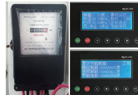
江蘇揚州高郵市元件加工廠，使用 1 臺 22KW 空壓機，經測試儀測試，平均空載率達到 60%，每天空載耗電 52.8 度，每年多用電 15840 度，每年多用電費為 12672RMB。
